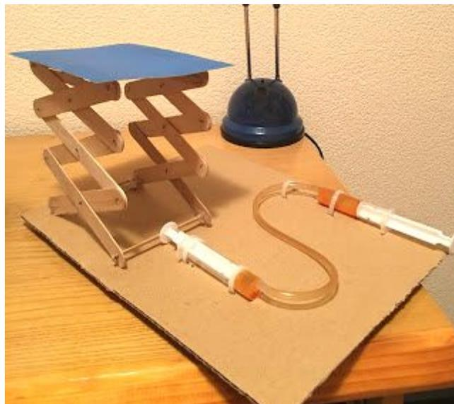
6. Probar el sistema. Empujando la primera jeringa hace que se extienda la segunda haciendo empujar al eje móvil de las columnas de tijeras. Al estar el otro eje fijo se consigue que las tijeras se eleven subiendo la plataforma elevadora de carga hacia arriba.
